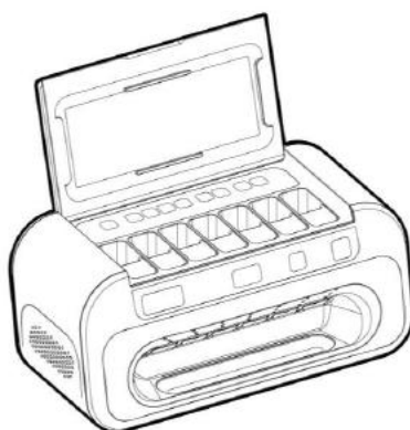
Exemplo de representação com uso de linhas contínuas com variação de espessura (BR302018055094)
