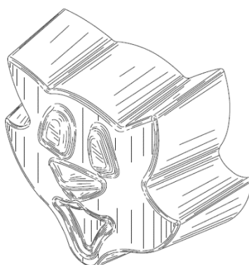
Exemplo de hachuras que interferem na compreensão da forma do desenho industrial e podem sofrer exigência. (BR302021003678)
