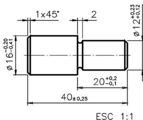
Exemplo de uso de linhas, cotas e indicação de escala que não fazem parte da configuração e não devem constar das figuras
